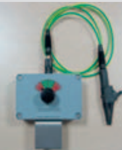
Unità di test TCT per la verifica del corretto funzionamento del sistema di messa a terra TERRACAP TCB040
